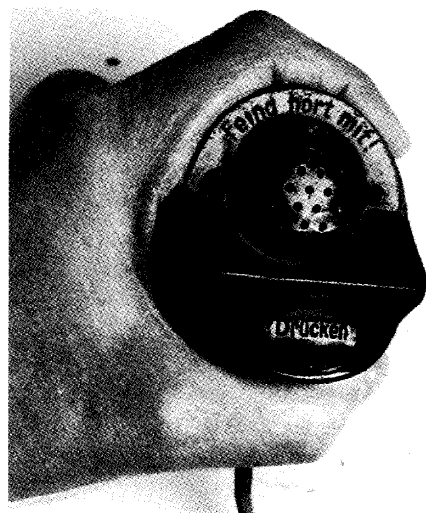
Fig.4. Het woord "ergonomie" zal nog wel niet hebben bestaan toen de handmicrofoon voor Duitse zendapparatuur werd ontworpen in de jaren dertig. Maar de microfoon is wel degelijk ergonomisch juist ontworpen. Door uitsparingen voor de vingers in het huis ligt de microfoon stevig in de hand. Door de duim iets te verplaatsen kan de zendknop worden bediend. (Foto: PAoSE.)
